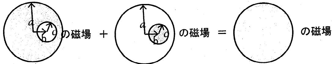
小円の中心での磁場はゼロ。求める磁場は中空部も埋まって同一電流密度で電流が流れている場合の磁場に等しい。
