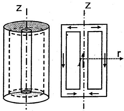
$$\text{中心円柱導体での電流密度は } j_a = I/\pi a^2$$
